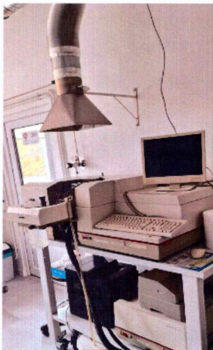
Zdjęcie nr 5. SPEKTROMETR SpectrAA 250 plus do oznaczania metali w próbkach wody. Autor fotografii Marta Sojka.
