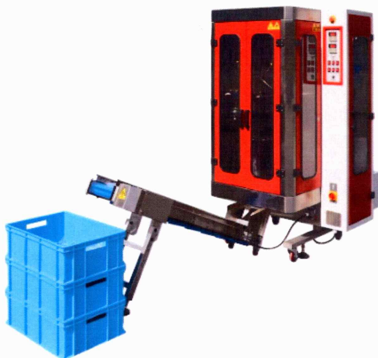
Rys. 1. Automatyczna paczkowarka wody pitnej. Źródło; https://proffico.com/produkty-woda/paczkowarka-wody-pitnej-aquapack-2-2/ .
