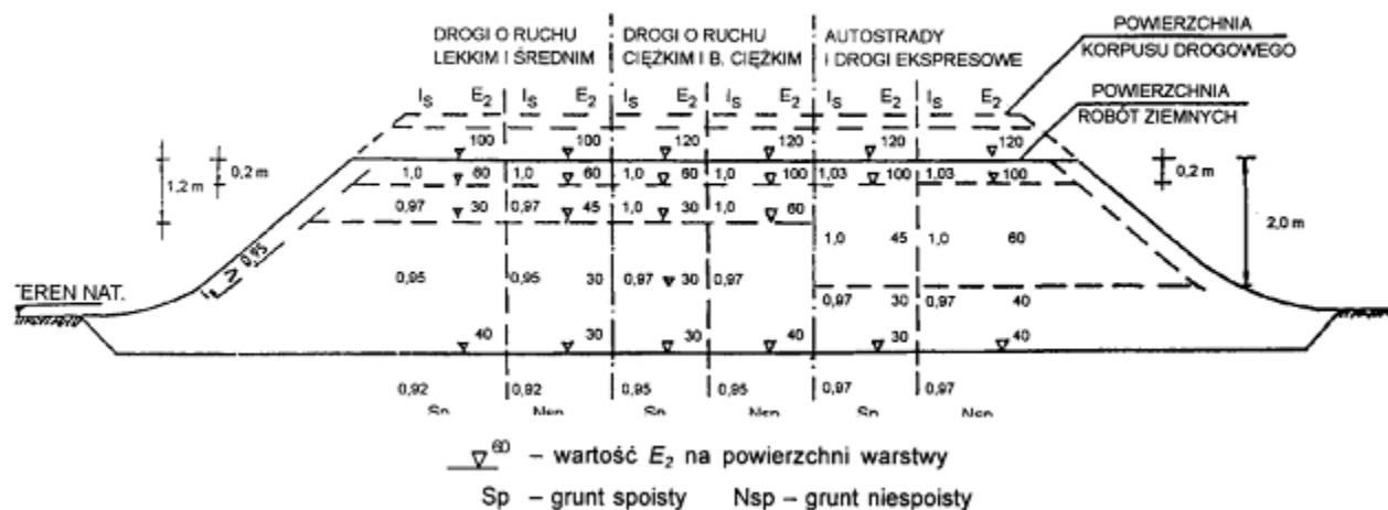
Rys. 1. Wartości wymagane w nasypach: wskaźnika zagęszczenia I_s i wtórnego modułu odkształcenia E , mega paskali [PN-S-02205:1998 rys.3]
