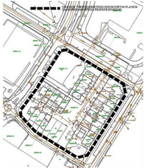
Rys. 2. Sieci kanalizacji sanitarnej i deszczowej
