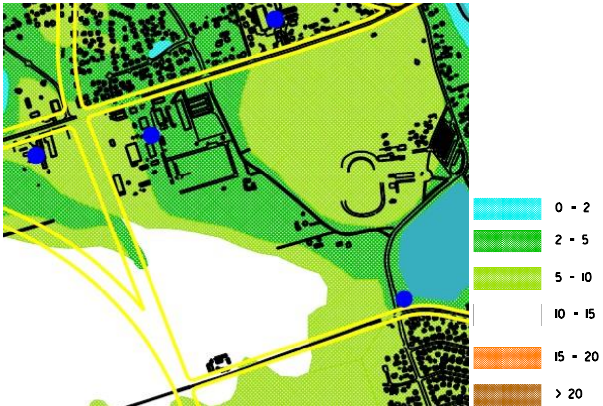
Mapa. 1. Wyciąg z Mapy Uwarunkowań Hydrologicznych (w legendzie podano głębokość do pierwszego zwierciadła wód podziemnych w m pod powierzchnią terenu)
