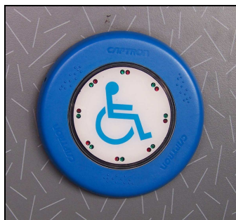
Fot. 3. Piktogram, mający na celu poinformowanie kierowcę o żądaniu dodatkowego obniżenia podłogi.
