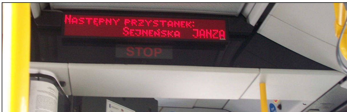
Fot. 13. Przykład wewnątrzpojazdowej tablicy wyświetlającej informacje dotyczące trasy linii oraz nazwę zbliżającego się przystanku.
