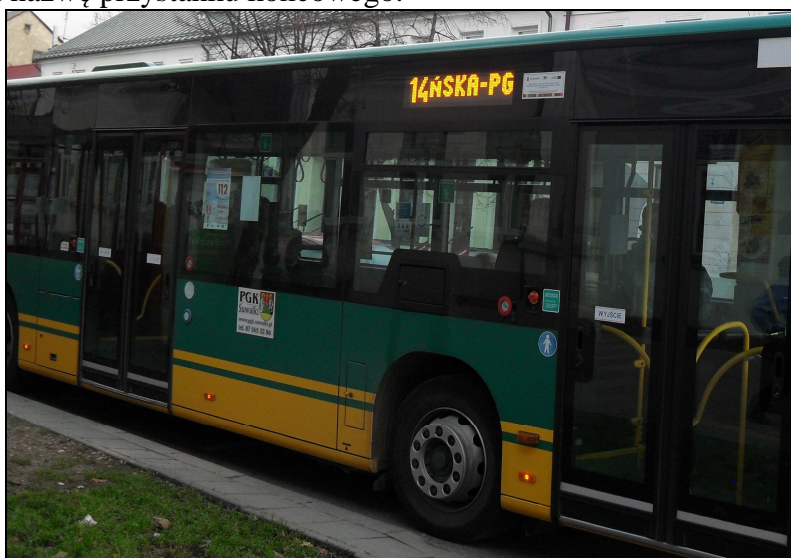
Fot. 11. Tablica zewnętrzna boczna, wyświetlająca numer obsługiwanej przez pojazd linii i nazwę przystanku końcowego.
