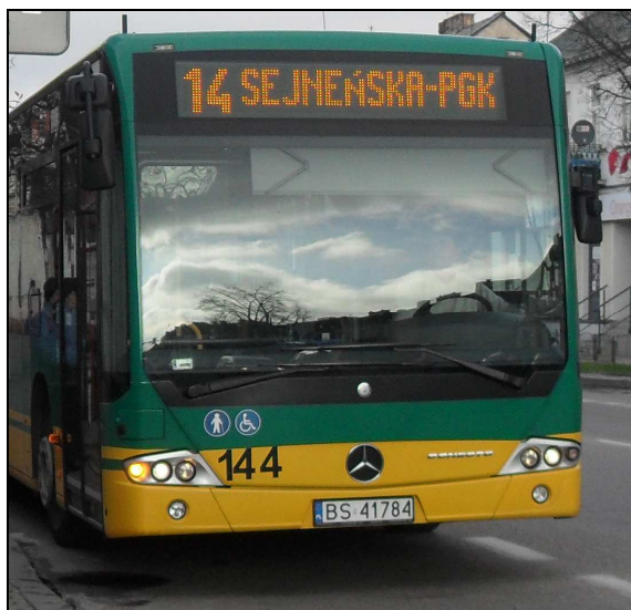
Fot. 10. Tablica zewnętrzna przednia, wyświetlająca numer obsługiwanej przez pojazd linii i nazwę przystanku końcowego.
