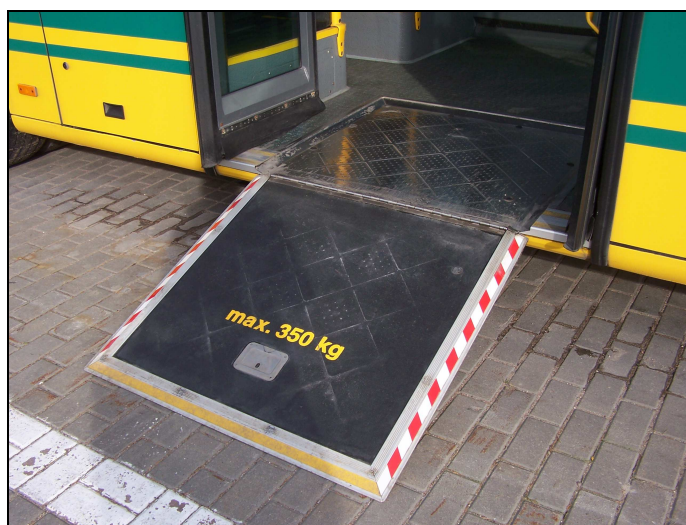
Fot. 6. Kłapa wysuwana z wnętrza autobusu na chodnik, mająca na celu umożliwienie dostania się do autobusu osobom poruszającym się na wózku
