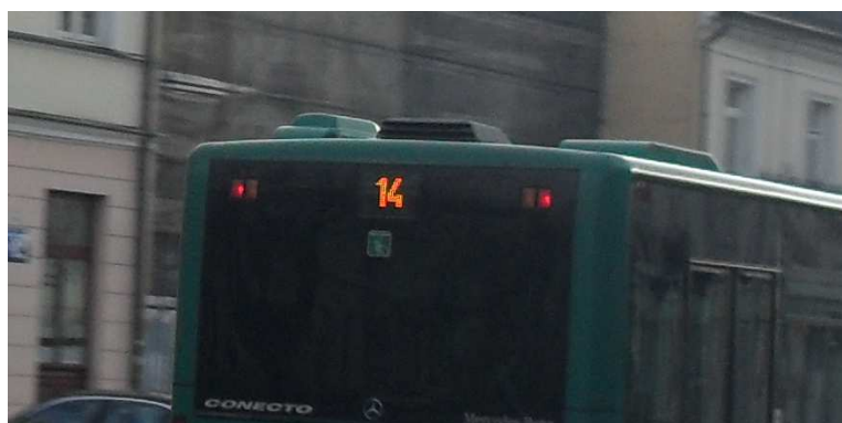
Fot. 12. Tablica zewnętrzna tylna, wyświetlająca numer obsługiwanej przez pojazd linii.
