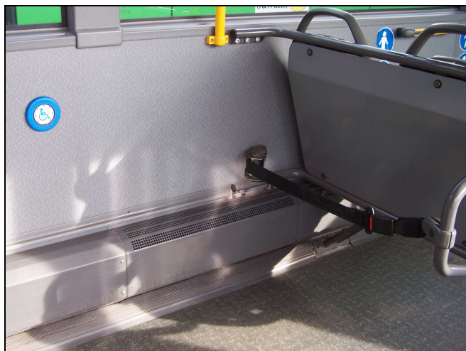
Fot. 5. Pas bezpieczeństwa, przeznaczony do zabezpieczenia osoby niepełnosprawnej na wózku w trakcie jazdy.
