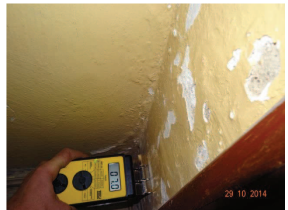
Fot. 35 i 36. Pomiar wilgotności w strefie pokazanej na fot. 34.
