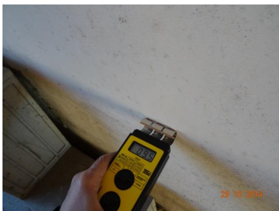
Fot. 20. Pomiar wilgotności ściany na poziomie ok. 1,5 m nad posadzką.
