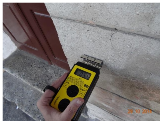
Fot. 10. Zawilgocenia ściany frontowej przy wejściu do budynku.
