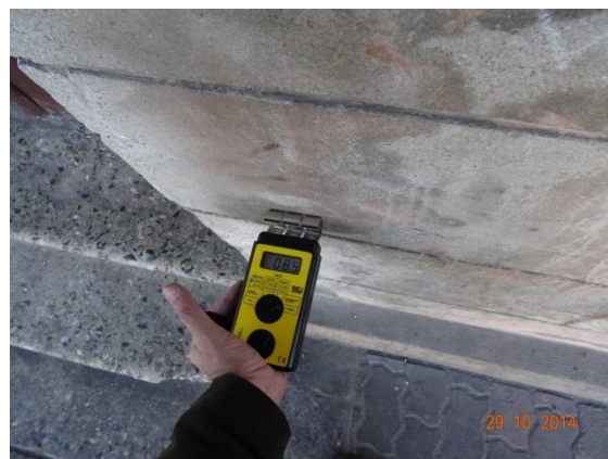
Fot. 11 i 12. Jak fot. 10, lecz pomiary wilgotności ściany przy prawej krawędzi otworu wejściowego w strefie mniej zawilgoconej i strefie bardziej zawilgoconej.
